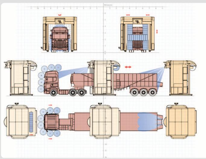
Автоматизированный комплекс состоит из моющего портала и системы оборотного водоснабжения, включая контуры водоочистки и утилизации отходов.
