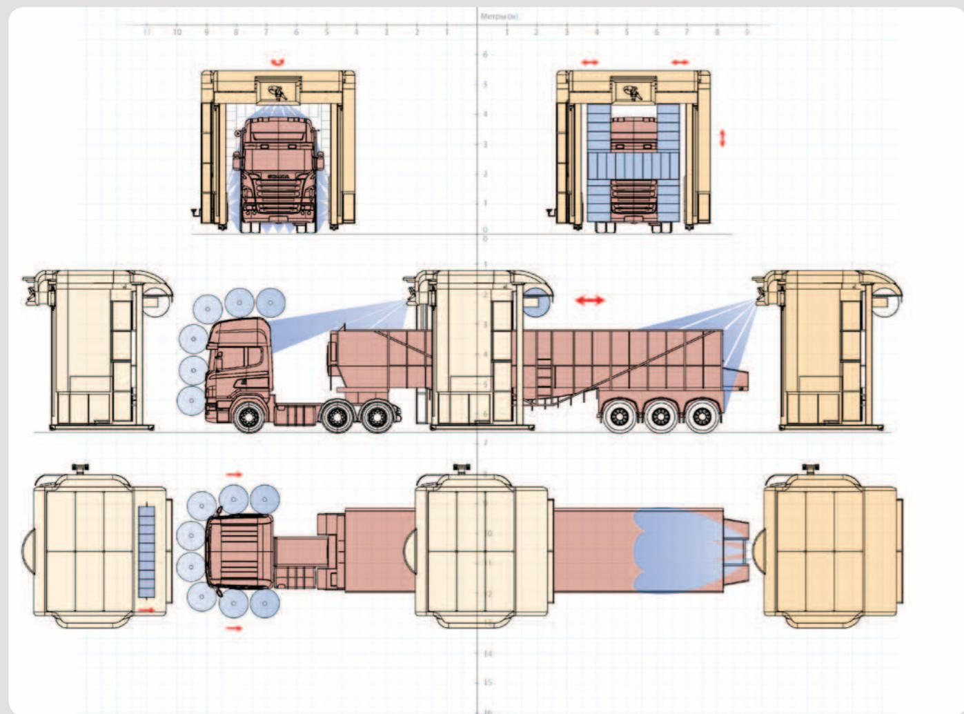
Автоматизированный комплекс состоит из моющего портала и системы оборотного водоснабжения, включая контуры водоочистки и утилизации отходов.
